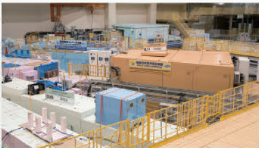
地球内部の高温高圧状態を実現する加圧装置。極微量の粉末状の試料を用います。
